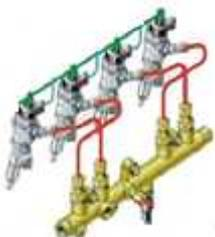
Qui a pour rôle de réguler la haute pression, d'amortir les pulsations créées par les injections et de relier les éléments de haute pression entre eux.
