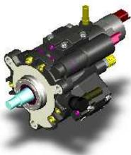
Dans laquelle est intégrée une pompe de transfert de carburant qui aspire le carburant du réservoir. Le conduit d'arrivée à la chambre haute pression de la pompe d'alimentation comporte une soupape de dosage de carburant qui régule la quantité de carburant fournie aux éléments de pompage haute pression en fonction de la situation de conduite.
